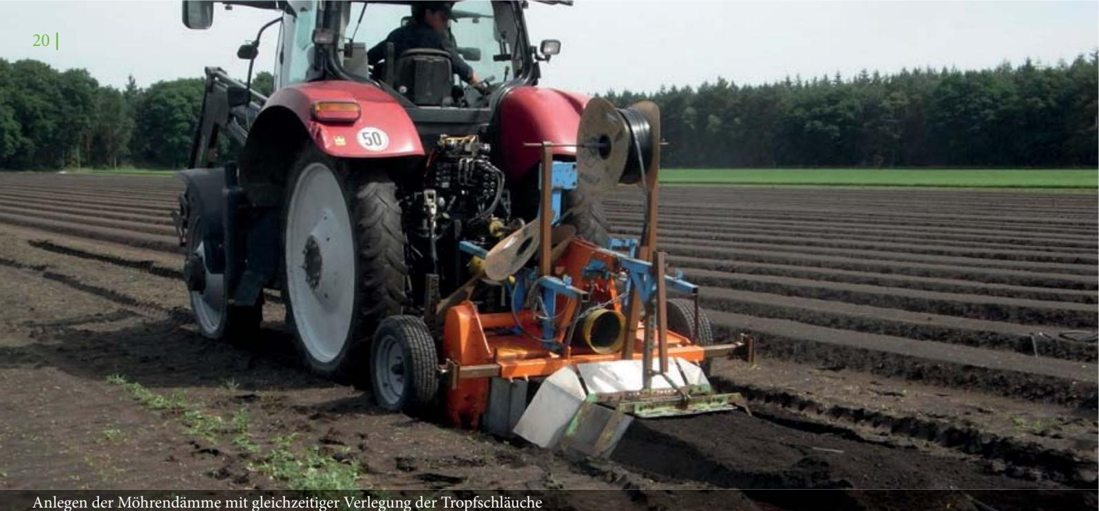
Anlegen der Möhrendämme mit gleichzeitiger Verlegung der Tropfschläuche
