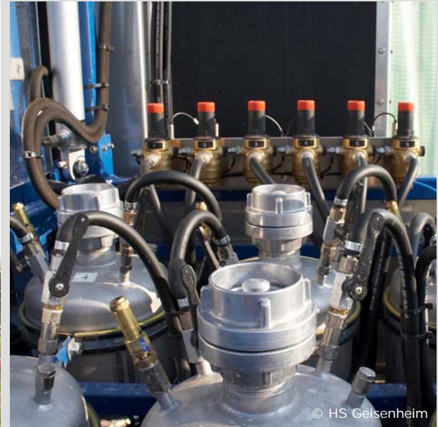
Parzellenspritzgerät-Druckbehälter und Druckminderer
